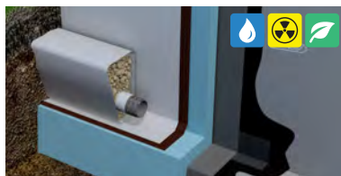
Muro enterrado con barrera de radón Sistema RAD4 180-48 P Elast
